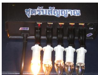
รูปที่ 4.1 เครื่องควบคุมระบบไฟฟ้าระยะไกล 1,000 วัตต์
