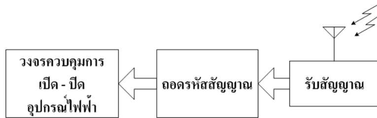
รูปที่ 2.6 แสดงบล็อกไดอะแกรมการทำงานของชุดรับสัญญาณวิทยุ
